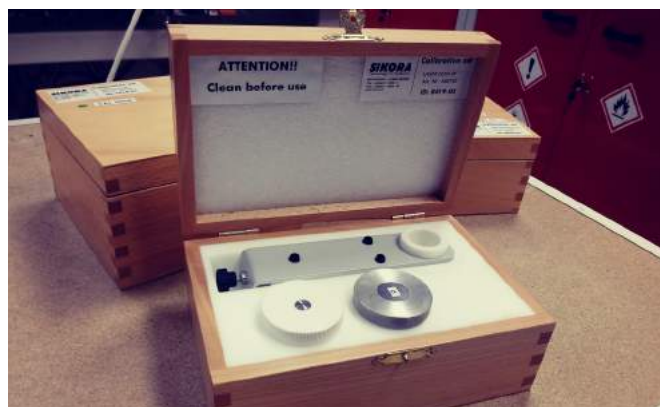
Zdjęcie. Zestaw kalibracyjny do sprawdzeń mierników średnicy i grubień
