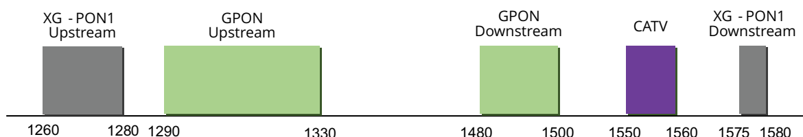
Rys. 3. Zajmowane spektrum optyczne w sieci pasywnej z zaimplementowanymi standardami GPON i XG-PON1, oraz nakładką RF, dla rozpowszechniania usługi telewizyjnej (CATV).
